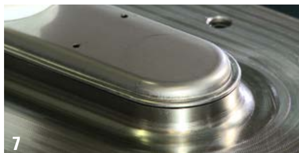
7 Połączenie obu części ramienia (wewnętrznej i zewnętrznej) przez okrężne falcowanie
