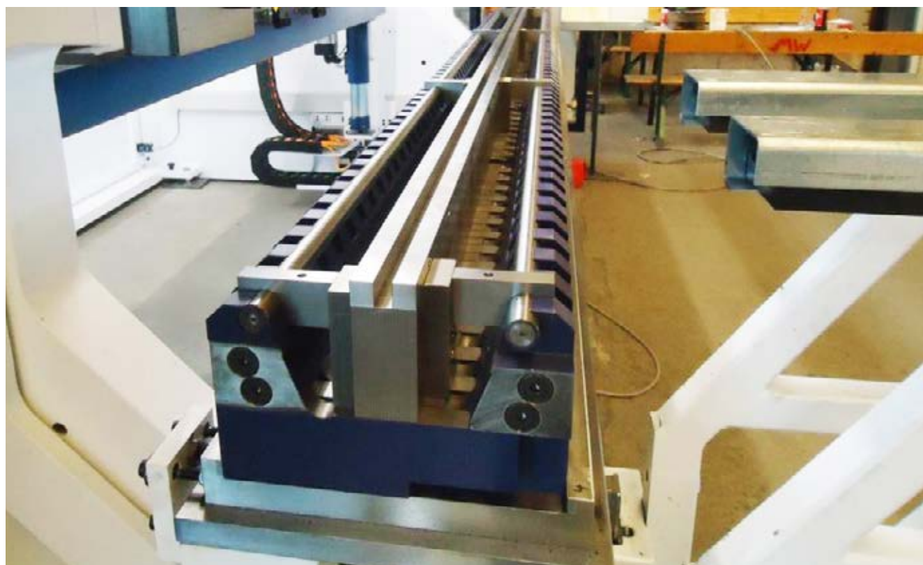
matryca przestawna z wstawionym adapterem szynowym
