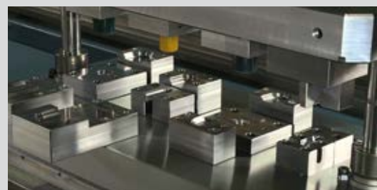
Kompletny widok prowadzonego na kolumnach narzędzia specjalnego do połączenia elementów łączących z pojedynczymi komponentami
