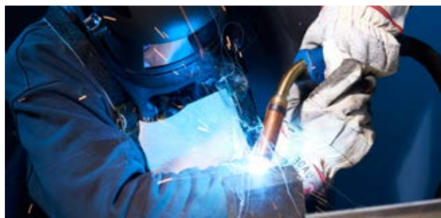
napawanie uszkodzonego narzędzia (metoda MAG)
