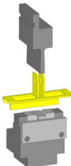
Narzędzie do gięcia U z małym wymiarem wewnętrznym i wgięciem w narzędziu dla gięcia 90°
