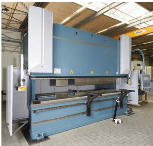
Prasa krawędziowa do gięć próbnych L = 4050 mm, nacisk: 3200 kN
