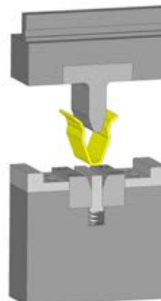
Stacja 2: Narzędzie do gięcia U z wypychaczem sprężynowym
